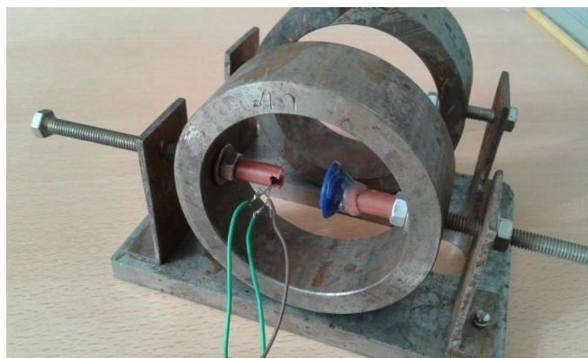
Рис.1. Общая схема чувствительной части (а) и макет (б) датчика усилия на базе эффекта Холла, работающего за счет деформации стального кольца цилиндрической формы
