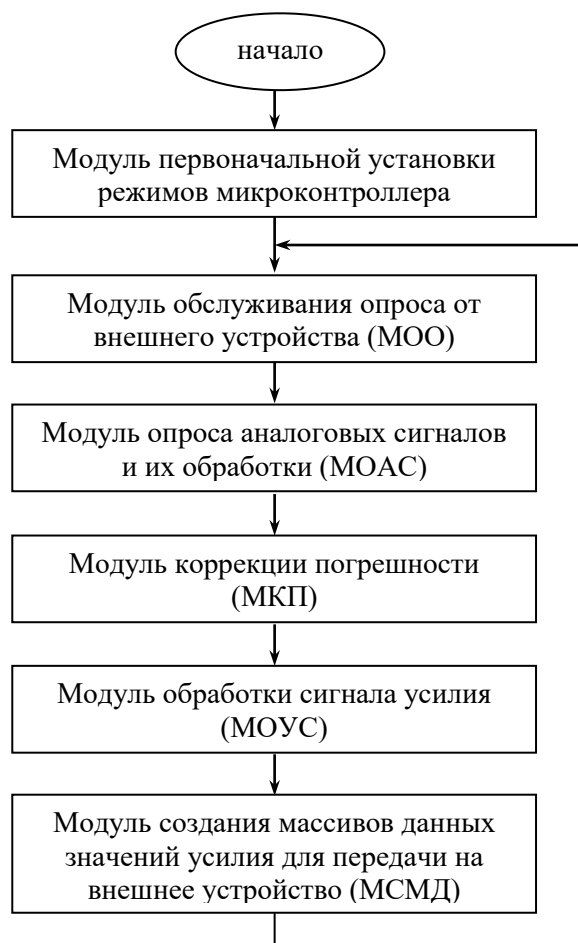
Рис.3. Упрощенная блок-схема алгоритма работы микроконтроллера LPC2148-STAMP для измерения усилия
